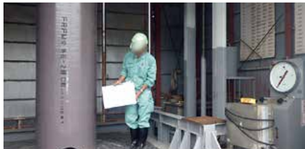
耐荷性能更生材(強化プラスチック躯体)(軸方向試験)
